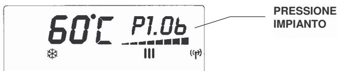
Quando la pressione è inferiore a quella richiesta (circa **P 1.06**), occorre ripristinare il valore corretto. Per effettuare l'operazione occorre:
