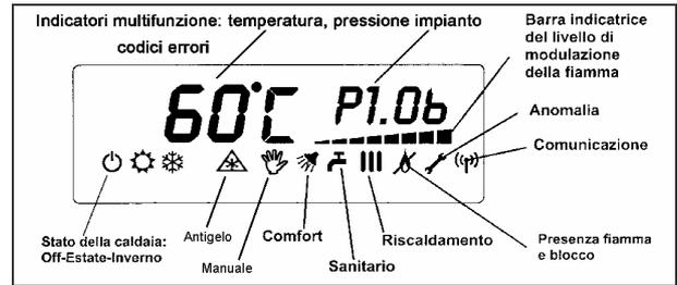
Figura 3-4 Display funzione caldaia [BOILER]
