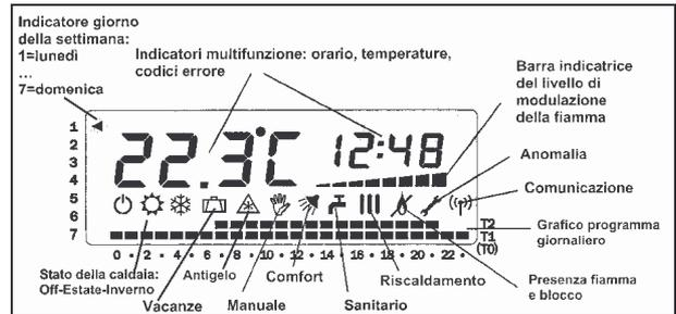
Figura 3-5 Display funzione Cronotermostato [CHRONO]
